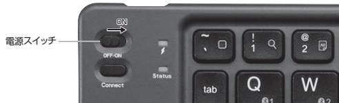
④ **[fn]**キーとペアリング切替ボタンを同時に押し、ペアリングする番号を選択・決定します。ステータスLEDが早く点滅します。
